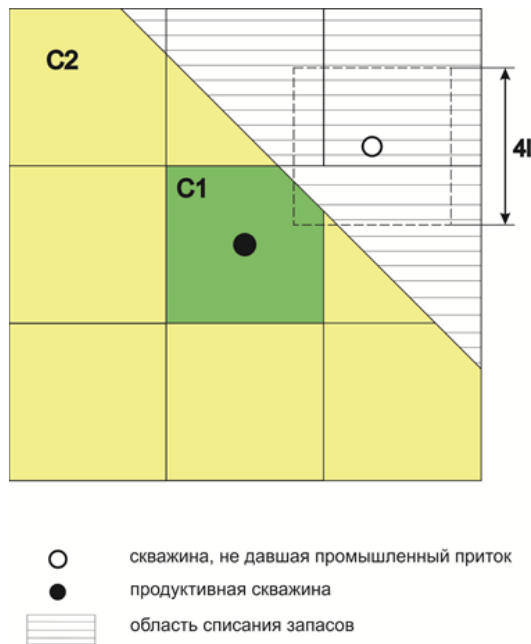
Рис. 9 Схема выделения категорий запасов при отрицательном результате испытания вертикальной скважины, пробуренной в категории C_2
